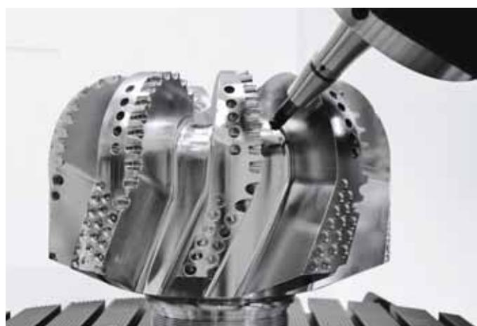
Kompletní obrábění vrtací hlavy na jedno upnutí s úsporou času 75 %
