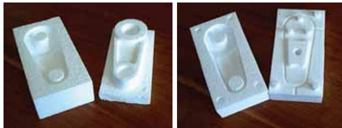
Obr. 9 Ukážka modelov pozitívu, negatívu a časti formy frézovaných do polystyrénu [5]
