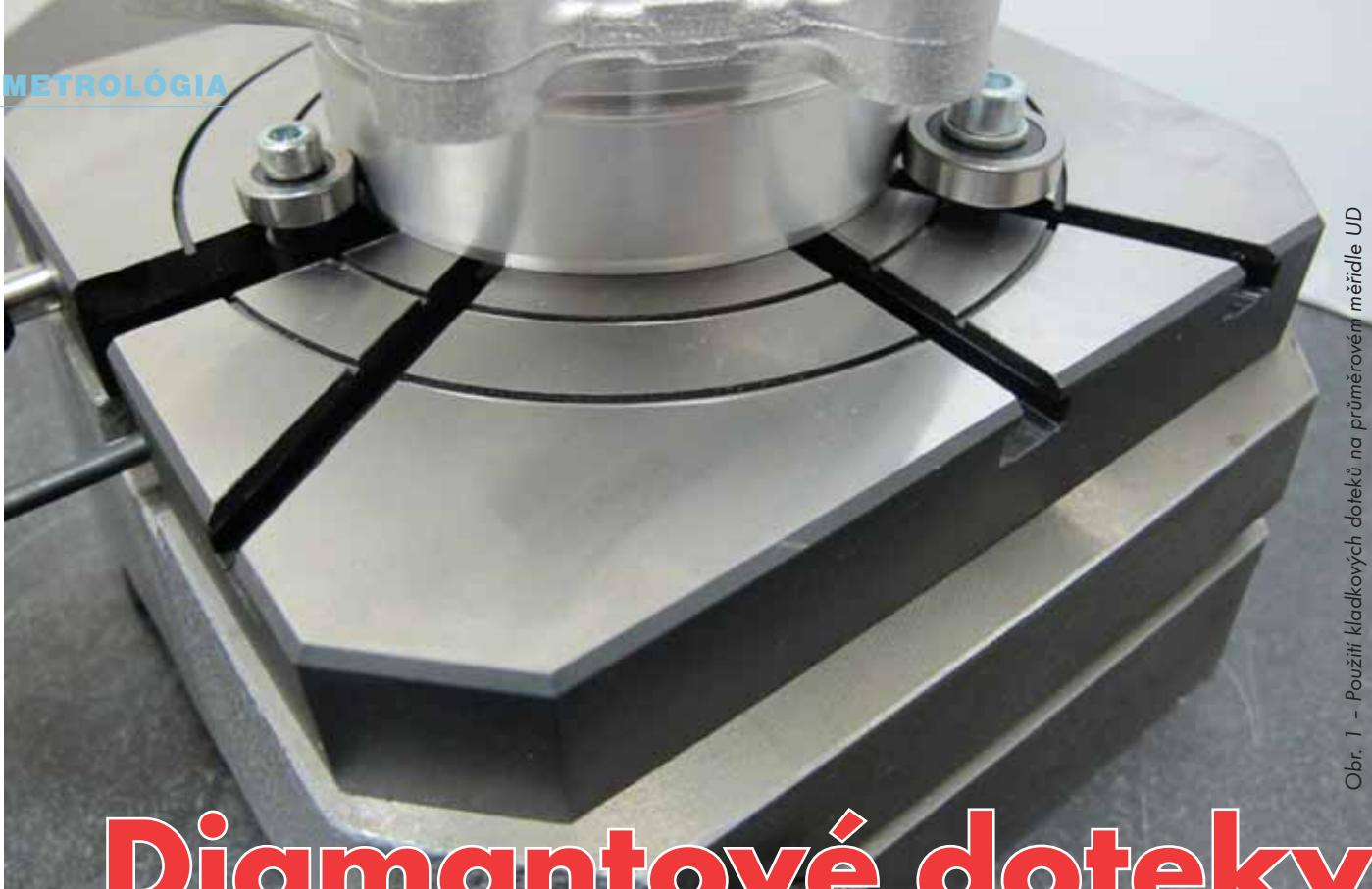
Obr. 1 – Použití kladkových doteků na průměrovém měřidle UD
