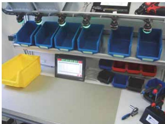
Obr. 2 Pick to light systém na montážnom pracovisku
