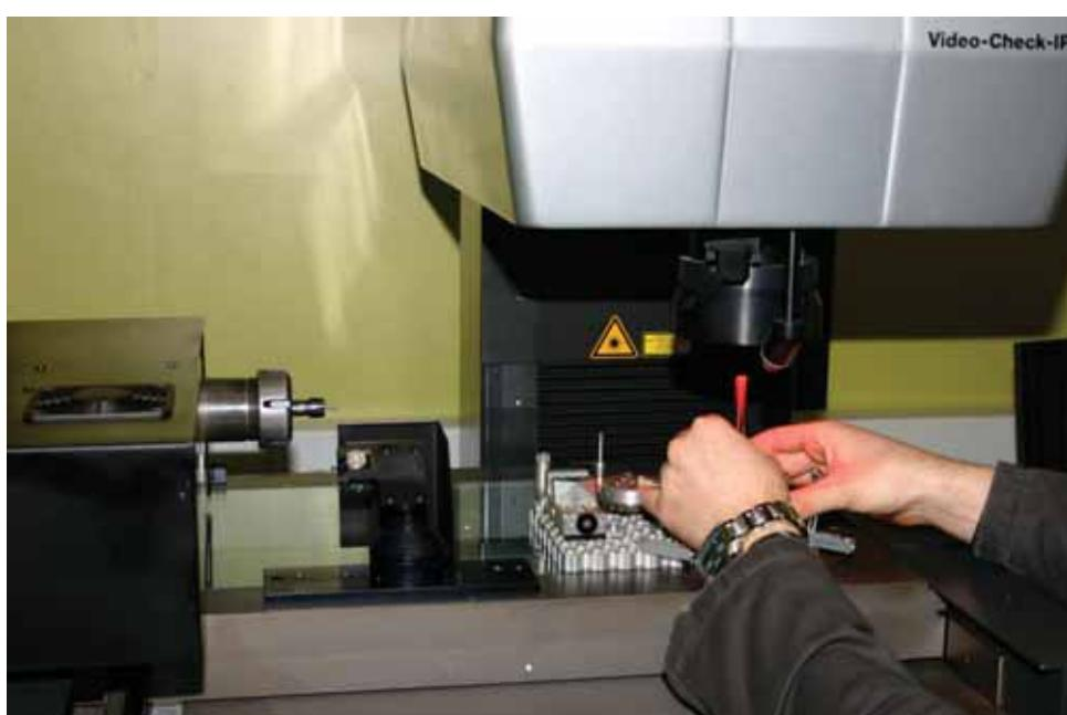
Obr. 3 Měřicí prostor byl navržen tak, aby všechny upínací prvky stále zůstávaly na měřicím stole přístroje, což umožňuje rychlejší výměnu dílců
