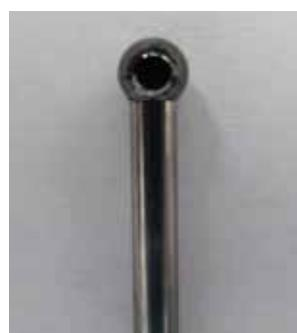
Obr. 3 Nanokrystalický diamantový dotek ø 3 mm
