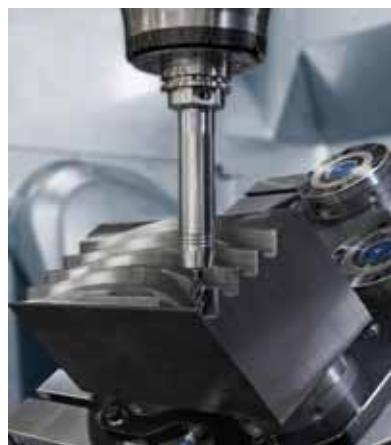
S priamym upnutím obrobkov sú upnuté priamo v rýchlovýmennom paletovom module použitím upínacích čapov.
