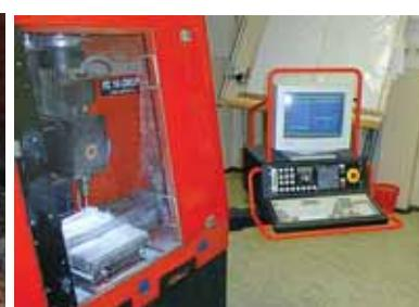
Obr. 7 Obrábanie modelov do polystyrénu na CNC frézovačke FC 16 CNC TOS Jasová [5]
