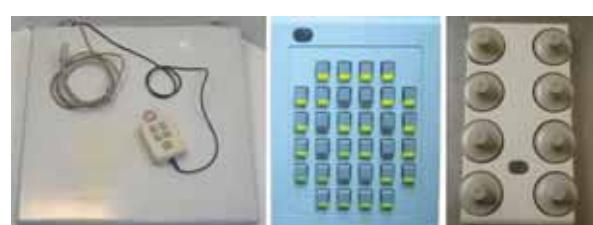
Obr. 3 Vstupné zariadenia pracovnej stanice IBM 320H s grafickým procesorom IBM 5086: tablet s kurzorom, svetelná programovacia klávesnica LPFK a „točítka“ – dials
