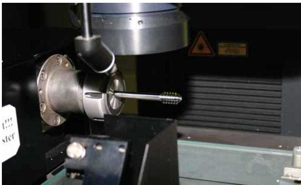
Obr. 2 Přidavná 4. osa multisenzorového měřicího přístroje zjednodušuje měření
