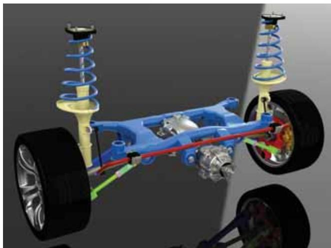
Obr. 13 Zostava modelu zadnej nápravy automobilu
