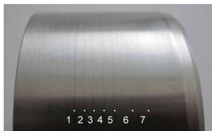
Obr. 5 Porovnání abrazivity doteků z různých materiálů
