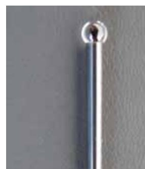
Obr. 2 Monokrystalický diamantový dotek ø 3 mm
