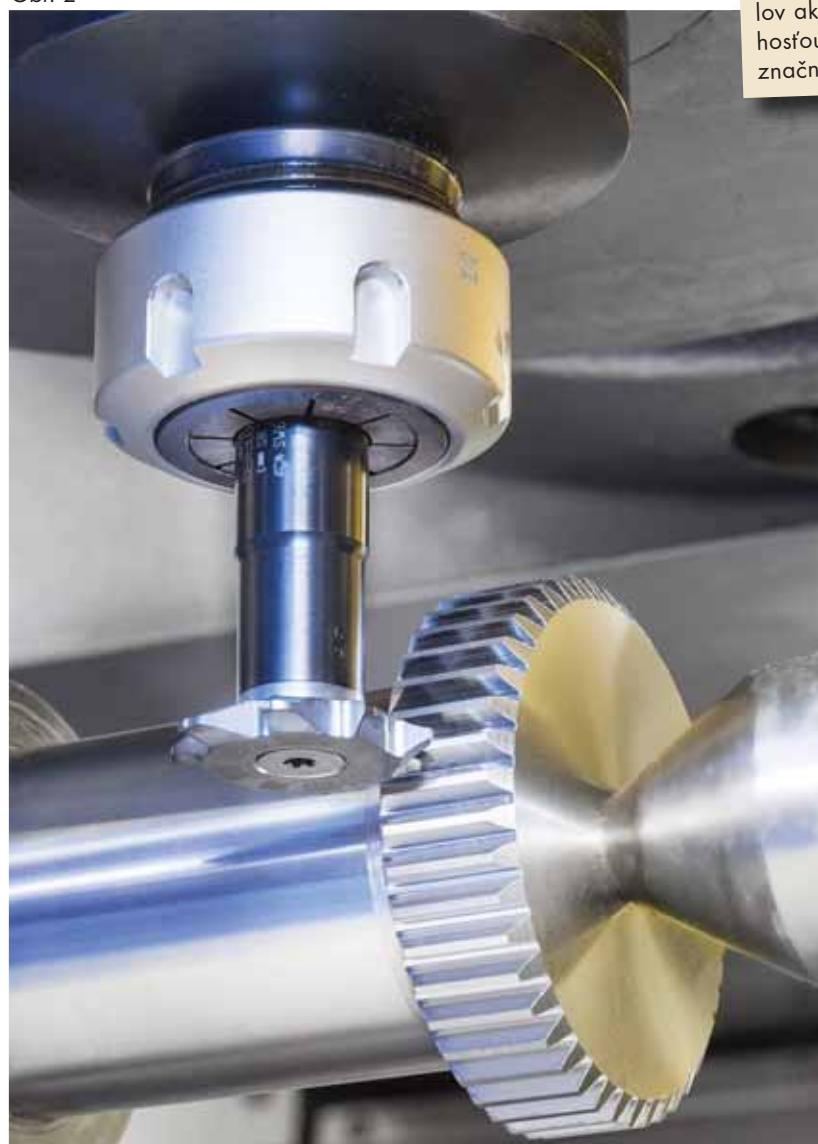
presné a spoľahlivé SP spojenie medzi stopkou a hlavičkou, definujú jeho rozsah použitia pre frézovanie evolventných profílov s modulom 1 – 2 mm.
