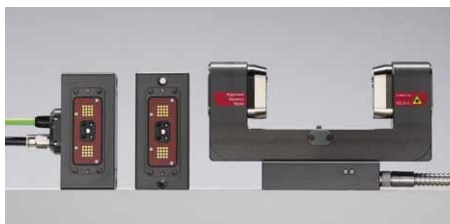
Kompaktní BLUM smartDock je standardní rozhraní pro všechny nové nosné systémy. K dispozici je ve třech variantách a kromě elektrických, mechanických a pneumatických připojek obsahuje i všechny potřebné pneumatické ventily.
