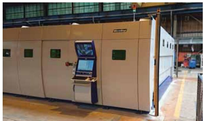
Obr. 4 Umiestnenie ovládacej konzoly riadiaceho systému na pohyblivej ochranej kabíne
