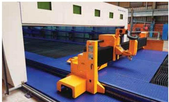
Obr. 2 Portál rezacieho stroja MSF-Max s úkosovou rezacou hlavou
