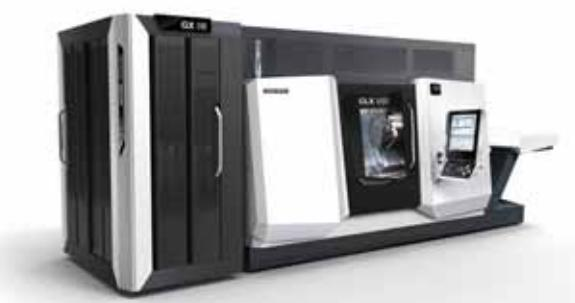
Nový zakladač GX 6 Gantry pro stroje řady CLX byl vyvinut na základě automatizace Gantry pro řadu NLX; dokáže pracovat s obrobky do hmotnosti až 6 kg
