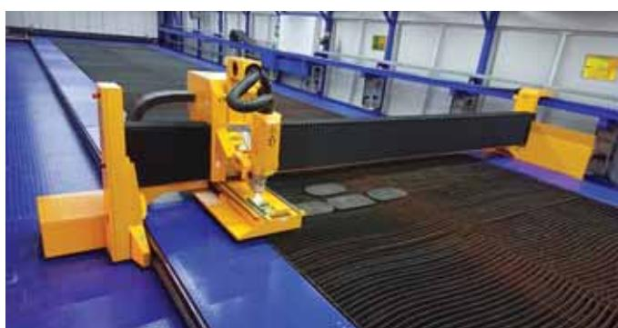
Obr. 3 Autokalibračný systém umiestnený priamo na portáli stroja
