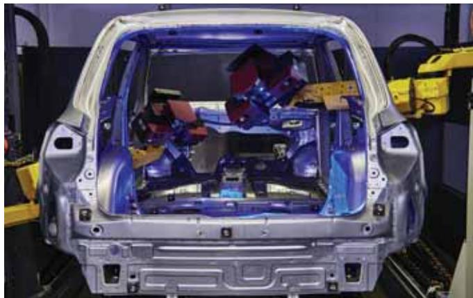
Měření pomocí ATOS ScanBox Series 8
