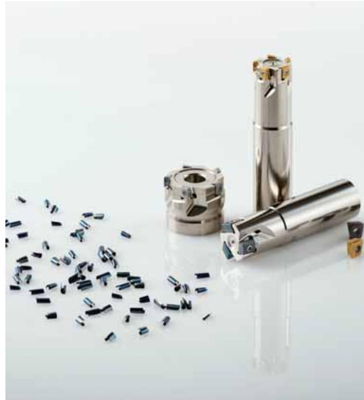
Frézy VPX 200 a 300 sú dostupné v dvoch veľkostach pre použitie vo veľkých aj menších strojoch. VPX 200 má doštičky veľkosti 09, VPX 300 má väčšie doštičky veľkosti 12. Oba typy sú dostupné vo vyhotovení so stopkou, nástrčné a so závitom, s rozmermi od Ø16 do Ø80.
