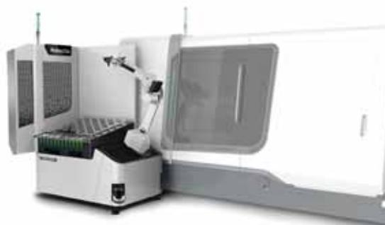
V podobě řešení Robo2Go má DMG MORI v sortimentu mobilní manipulaci s obrobky, kterou lze flexibilně nasadit u četných univerzálních soustruhů a snadno naprogramovat pomocí CELOSu
