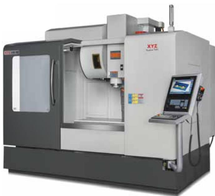
je, která poskytuje výjimečnou podporu pro osy X a Y a tím zvyšuje nosnou kapacitu stolu z 800 kg na 1 500 kg. Tento nový design zajistuje, že přesahy stolu jsou omezeny a tuhá konstrukce odlitku z šedé litiny, s kluzným, povrchově kaleným a broušeným vedením a kluznou vrstvou Turcite® na protiplochách, ještě dále zvyšují pozoruhodné možnosti stroje.
