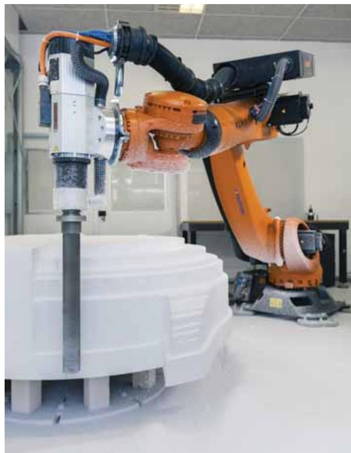
Robot o velké nosnosti umožňuje plně automatizovanou výrobu
