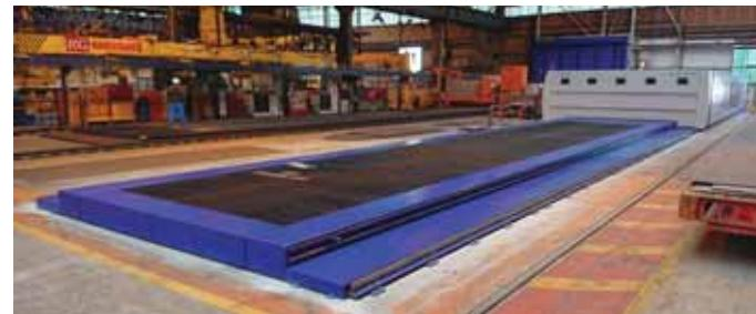
Obr. 1 Laserový rezací stroj MSF-Max s dvoma pracovnými plochami velkosti 21 x 3,5 m
