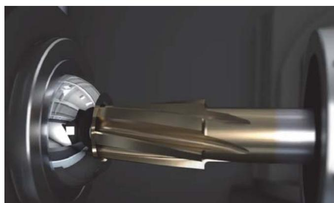
Dokončení kuželového otvoru provede speciální tvarový výstružník.
