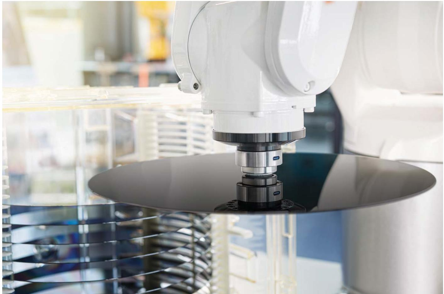
Vďaka uchopovacej technológií ADHESO dokážu uchopovače jemným spôsobom a bez externej energie zaobchádzať s citlivými komponentmi. Spoločnosť SCHUNK vyvinula túto technológiu v spolupráci so startupovou spoločnosťou INNOCISE.
