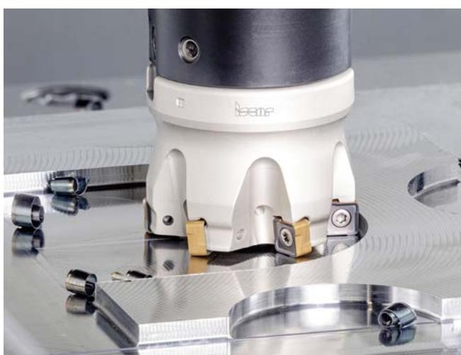
Obr. 3 90-stupňová NEODO S890 čelná fréza.
