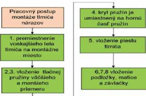
Obr. 4 Pracovný postup montáže tlmiča nárazov
