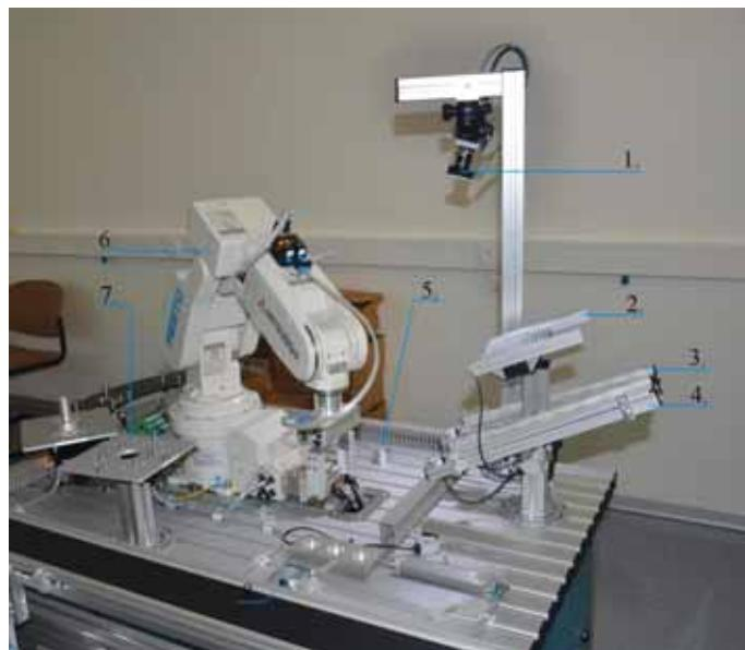
Obr. 1 Robotizované montážne pracovisko: 1. kamera, 2. zásobník pier, 3. zásobník vlhkomerov, 4. zásobník teplomerov, 5. robot RV-3SDB, 6. montážny modul, 7. držák obrobku pre kamerovú kontrolu, 8. systémová paleta
