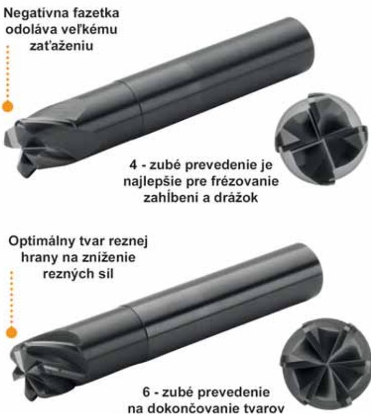
Pre maximálnu pevnosť a tuhosť, keramické frézy CESRB radu, majú optimalizované dĺžky 50, 60, 65 a 70 mm a dĺžky reznej hrany 4,5, 6,0, 7,5 a 9,0 mm – v závislosti na priemere nástroja. Vzhľadom na výkonové charakteristiky tohto nového radu keramických fréz, Mitsubishi odporúča, aby ich zákazníci používali na robustných obrábacích strojoch so zodpovedajúcim typom upínača nástroja – napr. presný hydraulický upínač Nikken.
