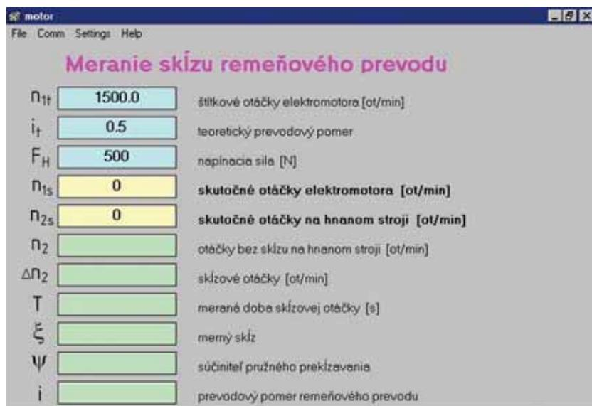
Obr. 2 Pracovná plocha softvéru na meranie sklz u remeňového prevodu
