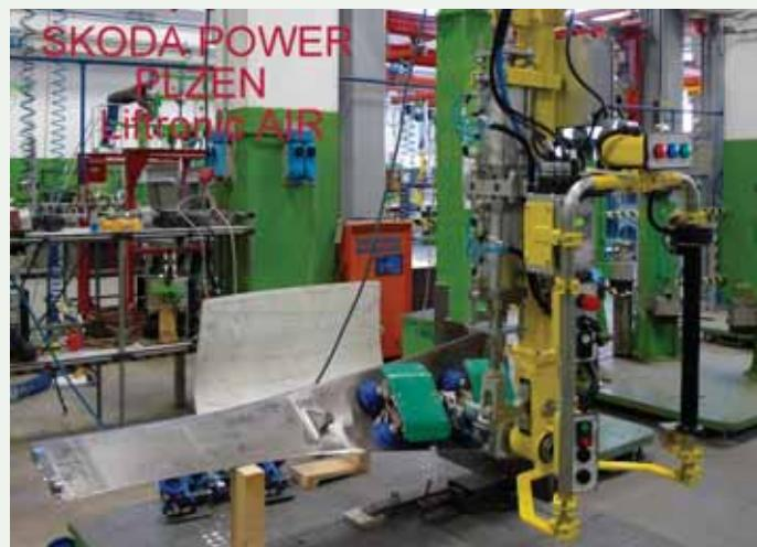
Balancéry sú elektronicky riadené systémy stáleho vyvažovania hmotnosti bremena do stavu „bezťaže“. Umožňujú jednoduchú manipuláciu s bremenom až do hmotnosti 310 kg, pri ktorej je námaha redukovaná na minimum a bremeno kopíruje pohyb ľudského ramena.
