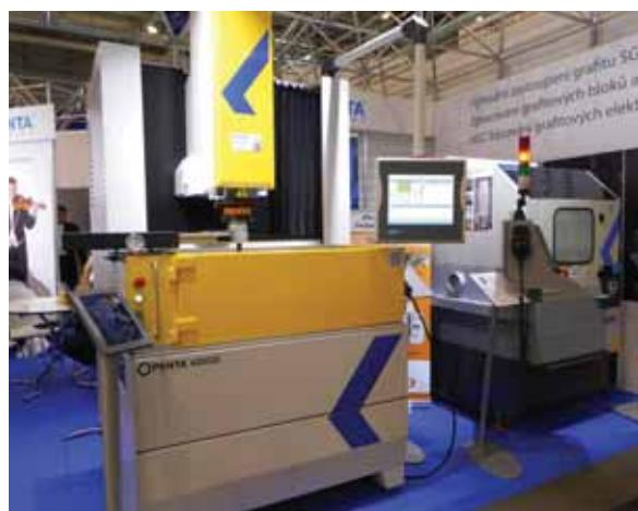
Hlbička PENTA 433 je najmenší model EDM hlbičky, ktorý je vyrábaný v Prahe. Stroj je vybavený novým generátorom, nemeckou elektronikou a českým riadiacim systémom.
