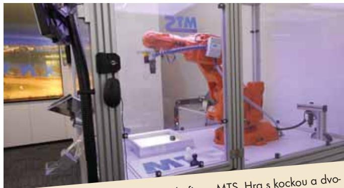
Robot na hranie, aplikáciu pripravila firma MTS. Hra s kockou a dvojmi figúrkami, kde nejde len o zábavu, ale hlavne demonštráciu úchopu a kamerového systému.
